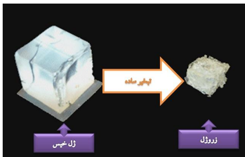
تصویر ۹ - خشک کردن به وسیله تبخیر ساده و تولید زروژل [۸]
