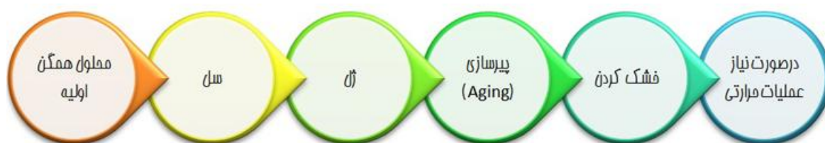
شکل ۸ - مراحل مختلف سل ژل و جایگاه فرآیند Aging در آن
